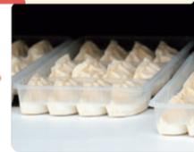
餃子の形に成型し1粒ずつケースに入れ、75℃以上で1分加熱する。"羽根のものと"を流し込み凍結する。
