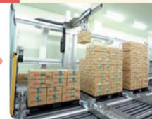
包装後、機械で異物検査を行い、重量を確認する。その後、生協へ出荷。
