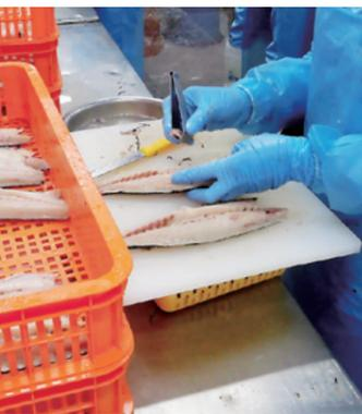
ベトナムの工場での骨取り作業の様子。「低い温度帯を維持しながら半身にしたさばの中心の骨を絶妙な包丁さばきで取り除き、次にピンセットで小骨をていねいに抜きます。最後は熟練の職員が残った骨がないかを隅々まで確認しています」(株極洋 宮宗邦享さん)
